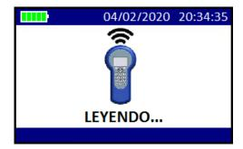
Una vez leidos todos los códigos EIC de los transpondedores, conectar el lector GES3S al PC mediante el cable USB y abrir el software Rumisoft.
